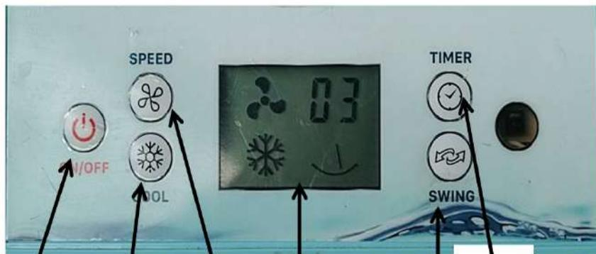
電源開關 — 製冷開關 — 顯示面板 — 風速切換鍵 — 定時開關 — 風擺開關
